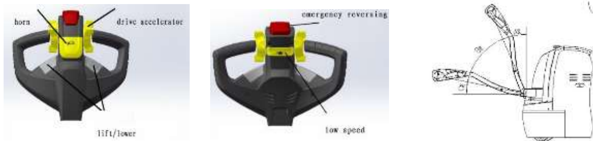
Рис.6 - Работа аварийного заднего хода погрузчика
