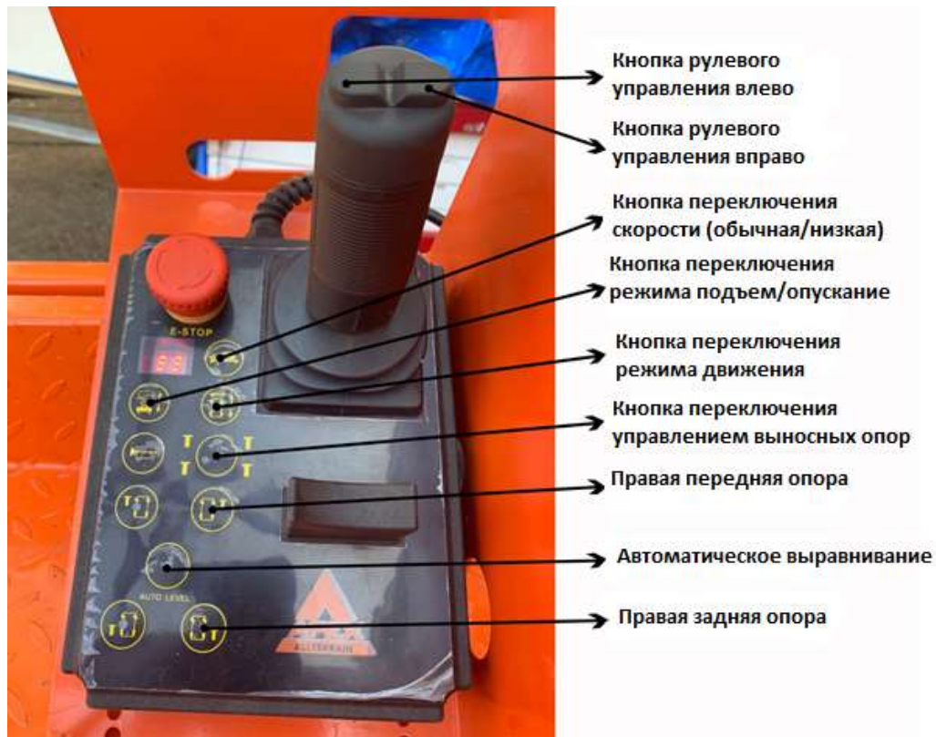
Рис.3 - Контроллер платформы подъемника гусеничного ножничного типа с автоматическими выдвижными опорами
