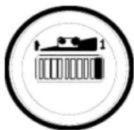
Батарея полностью заряжена
