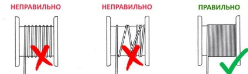
Рисунок 7. Правильность намотки грузоподъемного каната.
