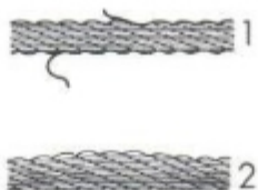
Проверка троса: (1) – использовать трос запрещено; (2) – трос готов к использованию.
